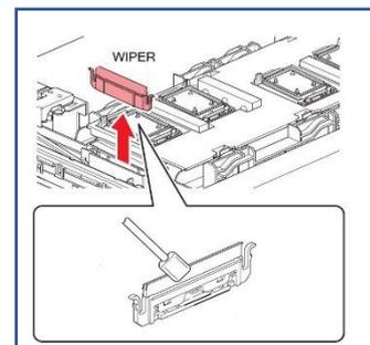
3. Eseguire manutenzione testa di stampa manualmente in posizione di manutenzione.
